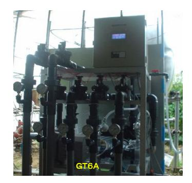
GT6A、GAT6A 本体装備機器 簡単操作のタッチパネル 毎分100L灌水ポンプ φ3 200V 750W φ40#120ディスクフィルター 灌水量測定流量発信器 2液式定量ポンプ φ3 200V 100w 原液タンク設定量給水電磁弁
